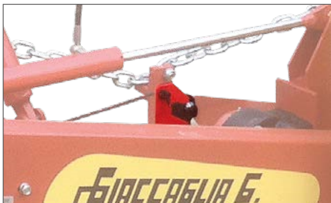
Dispositivo bloccaggio barra per trasporto su strada / Security Hook
