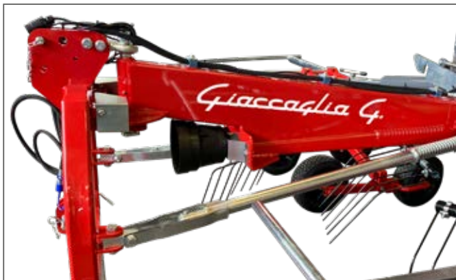
Particolare tiro sterzante con stabilizzatori / Articulated 3° point linkage with stabilizers
