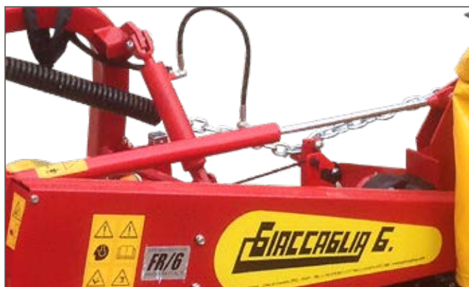
Martinetto idraulico per regolazione altezza di taglio Hydraulic device for adjustable height cutting
