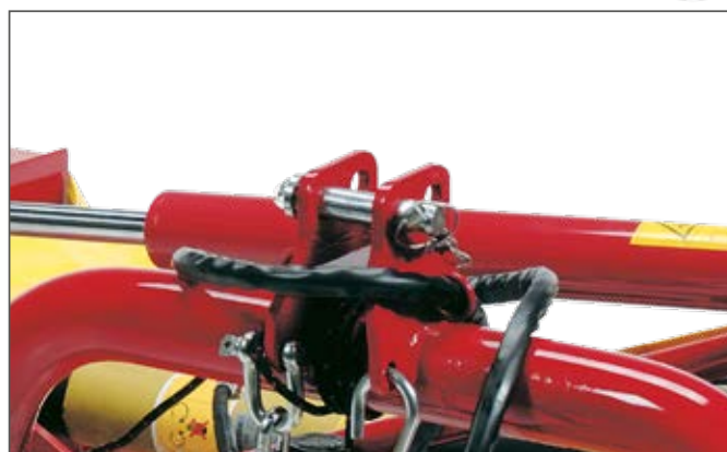
Dispositivo di sicurezza in caso di urti / Safety device in case of collisions
